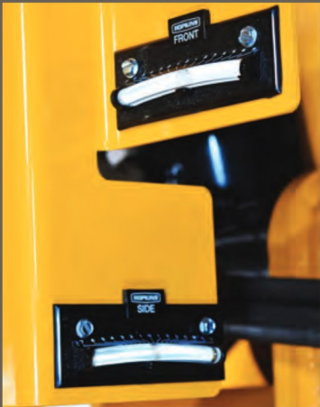
Dos indicadores de nivelación numerados y de lectura rápida para aplomar los postes.
